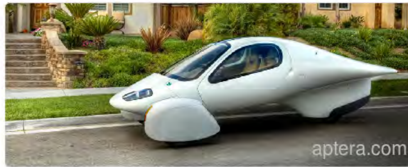
6 kWh per 100 km
